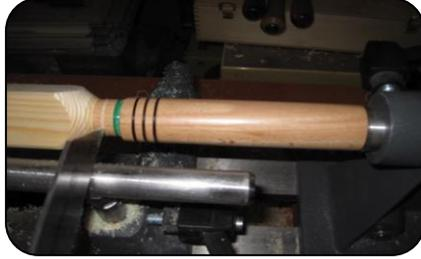
Er wird nun mithilfe eines Hilfsholzes, das im Reitstock eingesetzt wird, abgestochen. Dieses Holz verhindert das Wegfliegen des abgestochenen Ringes.
