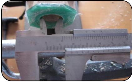
Zwischendurch immer mit einem Messschieber kontrollieren.
