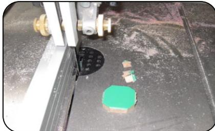
Von den geklebten und getrockneten Ringrohlingen an der Bandsäge die Ecken absägen. Dieses vereinfacht später das Runddrehen an der Drechselbank.
