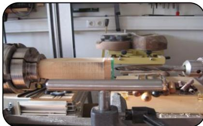
Ringrohlinge mit Weiconkleber auf das Blindholz kleben, in ein passendes Drechselfutter einspannen und bis auf das Blindholz mit einem 10mm Holzbohrer mittig durchbohren.
