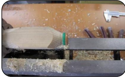
Das Blindholz wird nun abgedreht, so dass der Ring umgedreht unter Spannung aufgesteckt werden kann und anschließend die zweite Seite, wie oben beschrieben, fertiggestellt werden kann.
