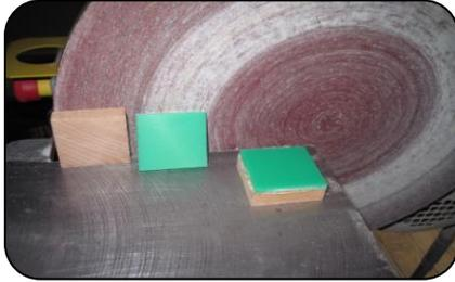
Holzstücke und Acrylglasstücke 35x35mm an der Bandsäge aussägen und schleifen, damit eine Verklebung mit folgendem Kleber hält.
