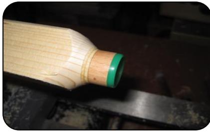
Es entsteht ein sichtlicher Glanz und der Ring ist außen und innen fast fertig.
